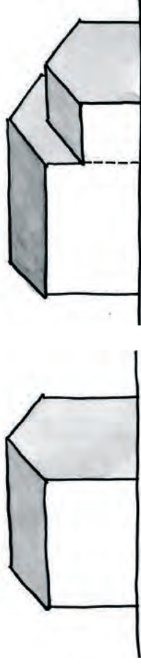
Corps principal et annexe (bâtiment secondaire)
